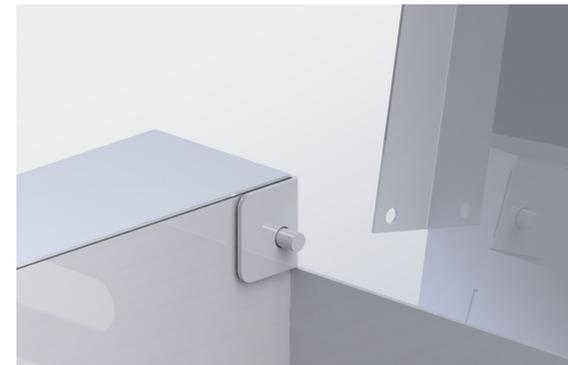
12° Del otro lado, fijar la tapa con el tornillo indicado.
