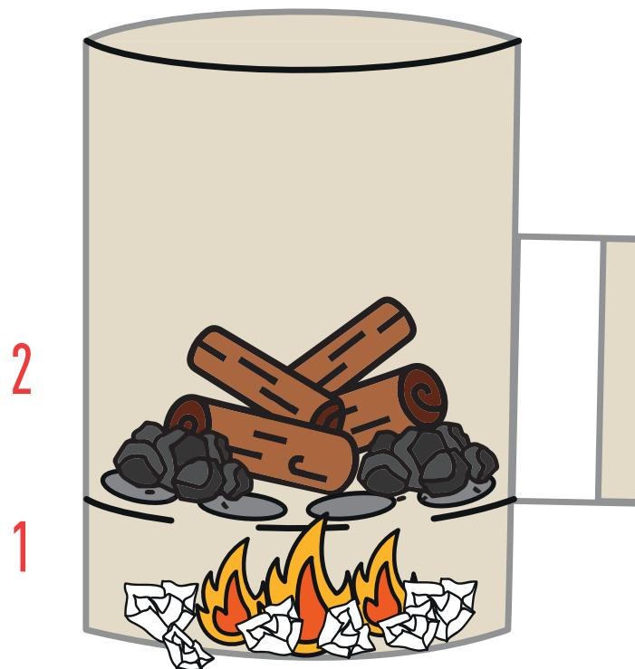
//1 Coloque bollos de papel en la parte inferior del cilindro.
