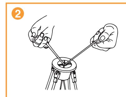
Tire de los cables del mecanismo de esclavamiento hacia afuera, haciendo que los postes de fibra de vidrio queden en su posición. Coloque el cordón suelto en el bolsillo proporcionado.
