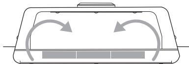
1 Placa refractaria y ranuras en sus laterales para permitir la circulación del calor hacia la zona superior de la pizza, logrando una cocción pareja.
